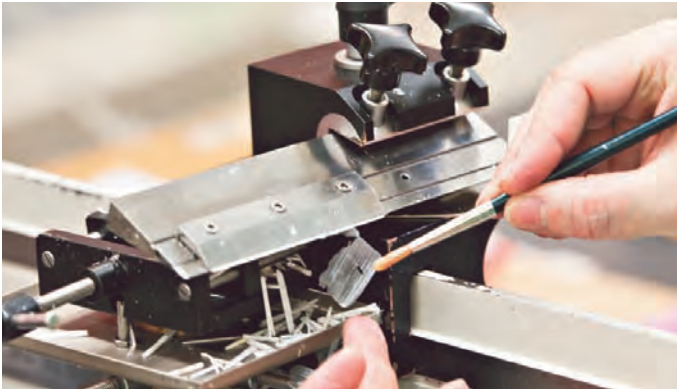
Mit einem Pinsel wird ein in Wachs gebetteter Gewebeschnitt (1/1000 mm) aus dem Schneidegerät entnommen.
