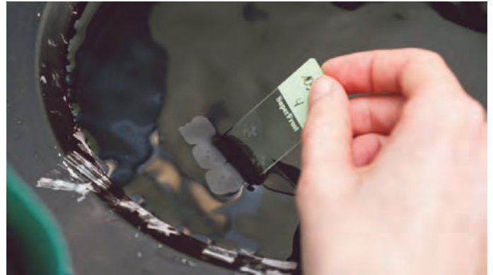
Der Schnitt wird auf ein Wasserbad gelegt, damit Falten wieder glatt werden, die sich beim Schneiden bildeten.
