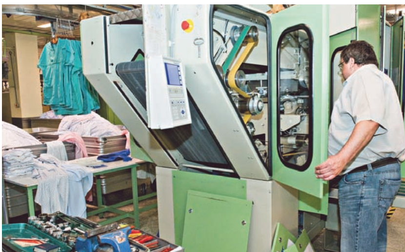
Martin von Mulert bei der Reparatur eines Finishers, in dem Hemden und Kittel gebügelt und zusammengelegt werden.
