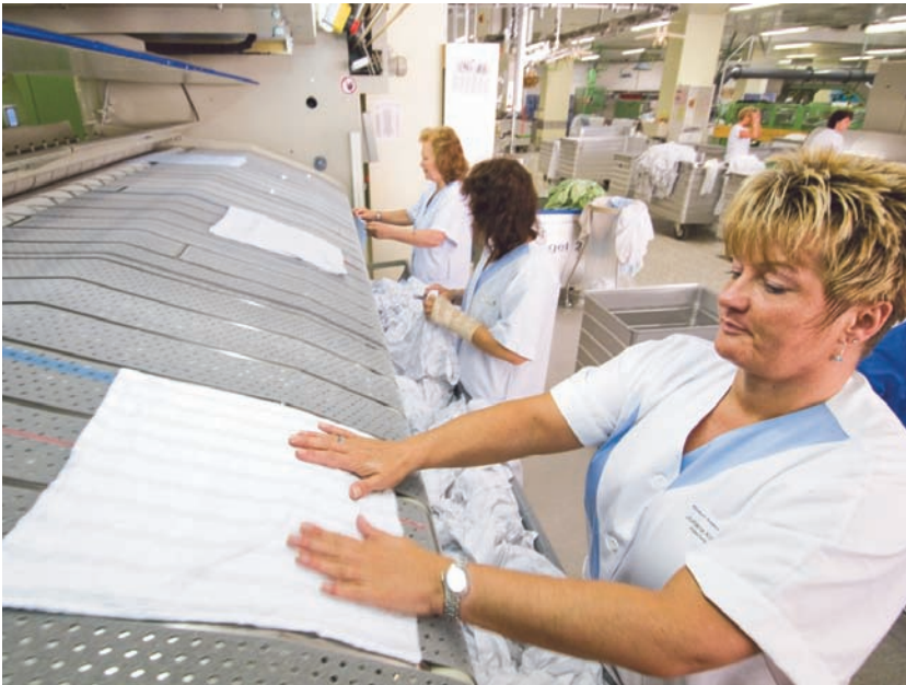
Ohne sorgfältige Handarbeit geht es natürlich auch beim Einlegen der Wäschestücke in die Mangelstraße nicht.
